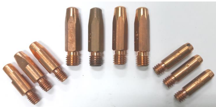
รูปที่ 1-9 แสดงลักษณะชิ้นส่วนท่อนำกระแส (Contact tube) (ที่มา : สุริยนต์ จิ่งแก้ว. 2560)
