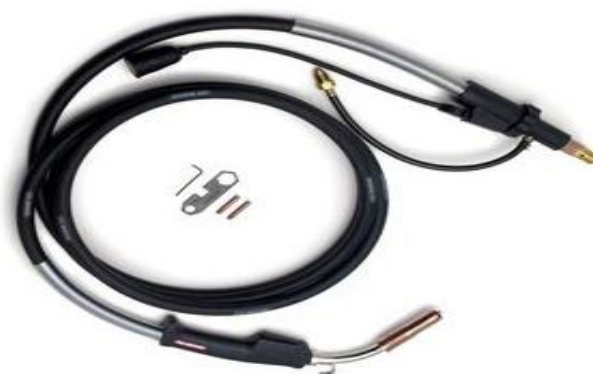
รูปที่ 1-14 แสดงลักษณะของสายเชื่อมงานเชื่อมอาร์กโลหะแก๊สคลุม
