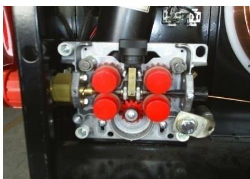
รูปที่ 1-19 แสดงลักษณะล้อป้อนลวดและล้อคัดลวดเชื่อมชนิด 4 ล้อ (ที่มา : สุริยนต์ ฉิ่งแก้ว. 2560)
